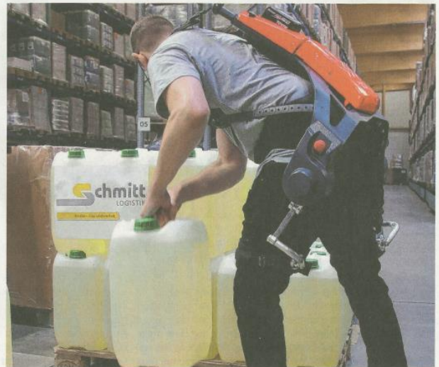
Unterstützt: Das Exoskelett verstärkt die Kraft der Mitarbeiter.
